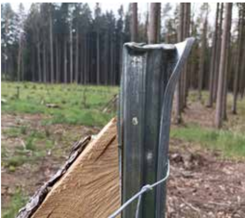
Poškození sloupku v případě, že nebyl použit zatlukací trn.
